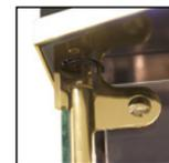
Arrêt des moteurs à l'ouverture des portes vitrées.
